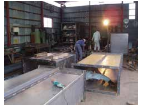
バケットエレベーター 寸法：W600×D1200×H21000
