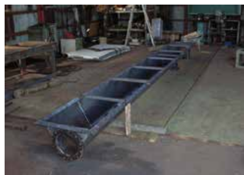
原料搬送用スクリーユ・ケーシング 寸法: 200 \text{ A} \times \text{L} 5000
