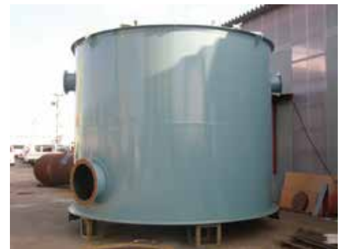
攪拌槽タンク 寸法：φ4022×H3070
