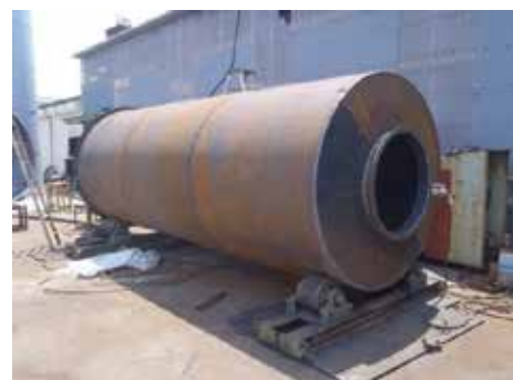
20 t タンク (鉄源粉貯蔵用) 寸法: \phi 2000 \times H 5000
