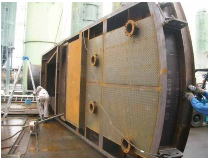
バケット着床粉塵対策 炉蓋製作・設置 寸法：φ6225×H589
