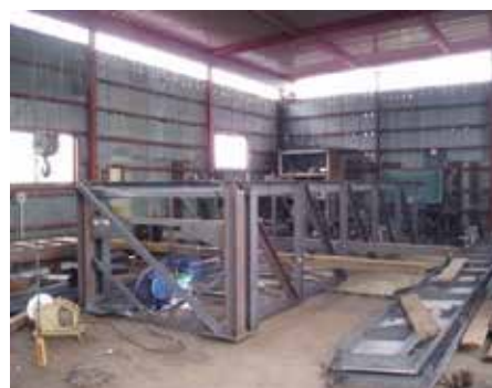
ベルトコンベアフレーム 寸法：1 スパン W3800×D3600：10 スパン
