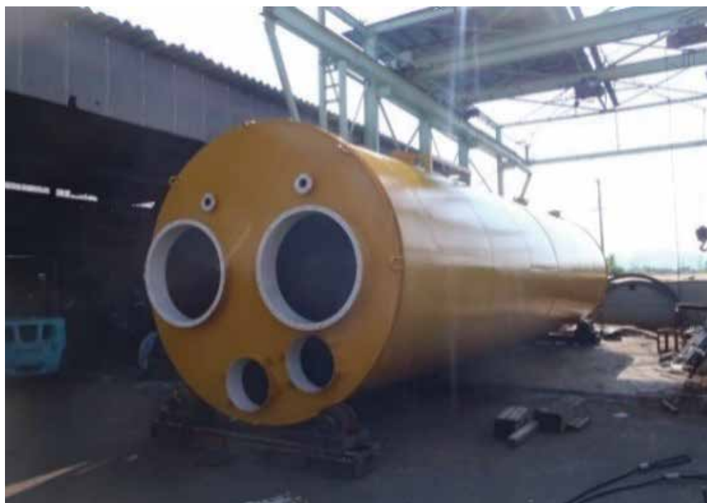
50 t サイロ (内部 2 分割※セメント・フライアッシュ) 寸法: \phi 2500 \times H9000
