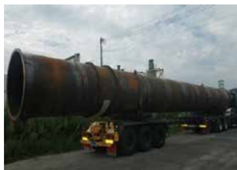
ダクト 寸法: \phi 1800 \times 20 \text{ m} \times 6 本製作
