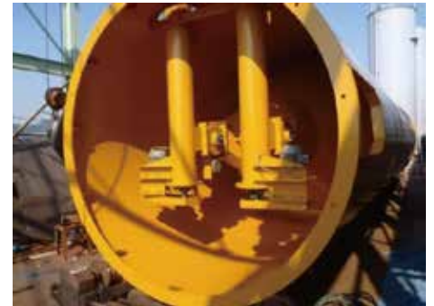
20 t タンク（鉄源粉貯蔵用） 寸法：φ2000×H5000
